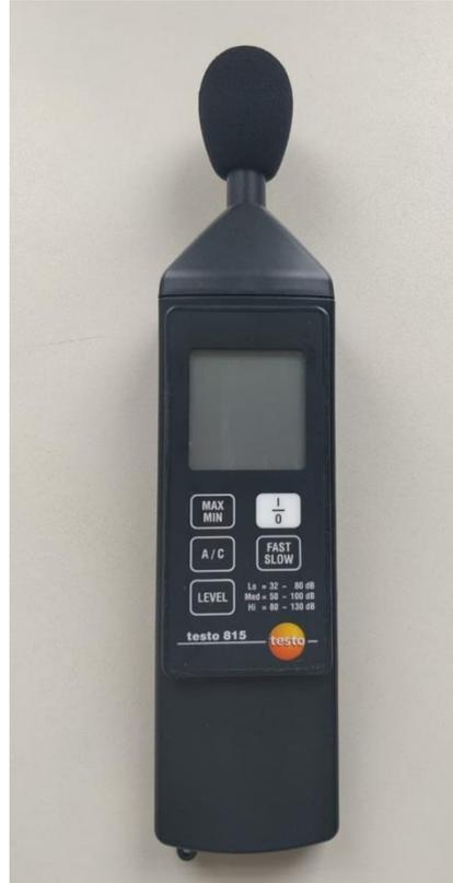
**A** BiVOC V2: 2-Kanal-Probenahmepumpe (Umweltanalytik Holbach GmbH) für die Probenahme der VOC. **B** Schallpegelmessgerät testo 815 von Testo Se & Co. KGaA.
